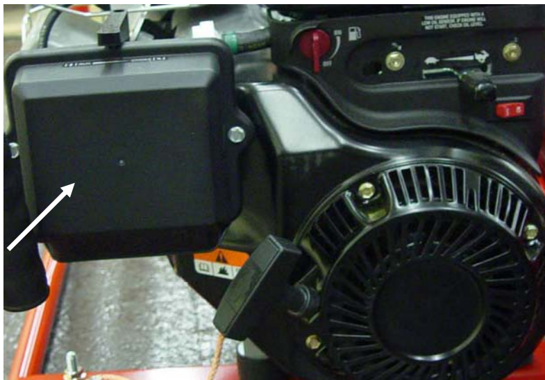
Рис. 4.8: Снятие воздушного фильтра
