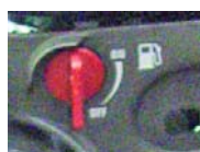
Рис 4.4: Выключение топливного крана
