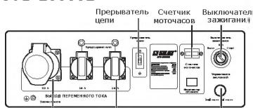
Выход переменного тока (Однофазный)      Выход переменного тока (Однофазный)      Управление заслонкой
