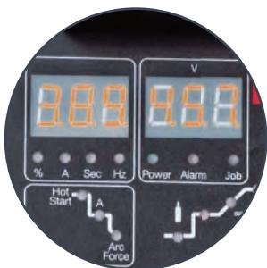
Цифровая индикация параметров сварки
