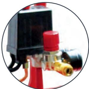
Разъем рапид для подключения пневмоинструмента
